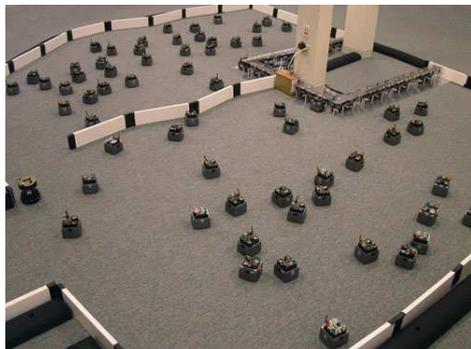
(a) Ejemplo de ejecución de los robot iRobot en una tarea de cobertura de superficie.
